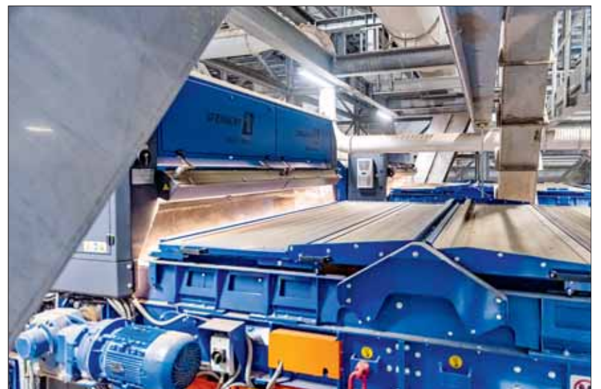
Die „Unisort Black“ sorgt für die zuverlässige Entfernung schwarzer Kunststoffe und Sortierung nach Holzarten.
